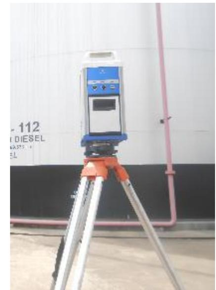
Escaneamento em 3D para análise deformações
