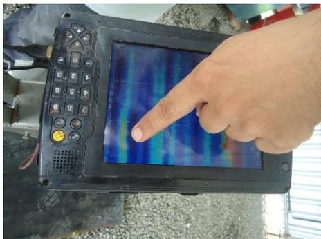
Devido ao seu baixo peso e a identificação de corrosão em tempo real é possível fazer a inspeção progressivamente em tetos, garantindo que o operador e equipamento não corram o risco de queda no interior do tanque em função de baixas espessuras.
